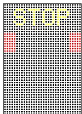
当航空器到达停机线时, 系统显示'STOP'的同时, 在方位显示区域显示2个红色矩形停止指示排灯, 而黄色接近速率光带消失。
